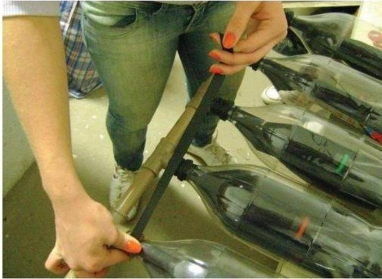
2) Cole o barramento inferior nas extremidades dos tubos de 1m que estão sem barramento. Assim, o módulo estará pronto para a próxima etapa.
