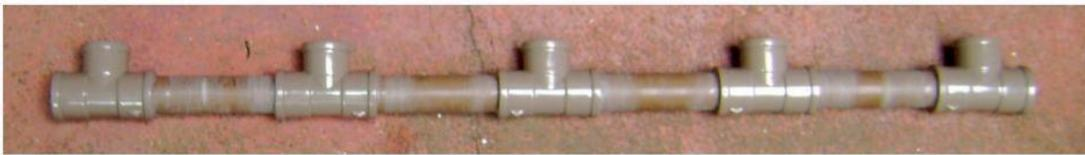
Feito os barramentos, basta encaixar os tubos de PVC de 1m nas conexões "T" de apenas um dos barramentos feitos inicialmente. Após o encaixe, pinte toda a tubulação com tinta preto fosco.
